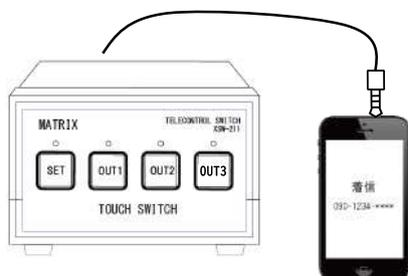
本装置と携帯電話を接続して遠隔操作する場合は、携帯電話の自動着信機能を使用して通話できるようにします。
