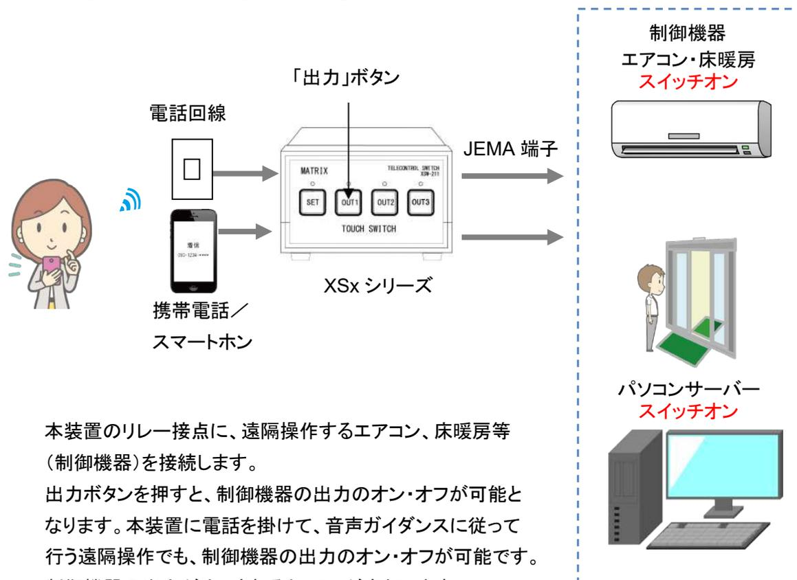
本装置のリレー接点に、遠隔操作するエアコン、床暖房等（制御機器）を接続します。
