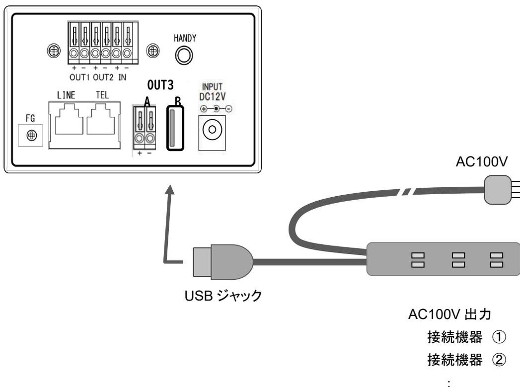
USB ジャックを本装置の OUT3-B(USB 連動タップ用)出力に接続することで、100V の ON/OFF 制御をすることができます。
