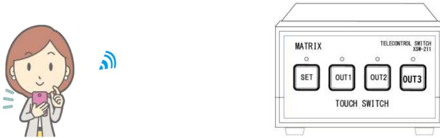
※本装置は、電話機のトーン信号(ダイヤルをする毎にピッポッパツのような音がして信号を伝えます)を感知して操作します。
