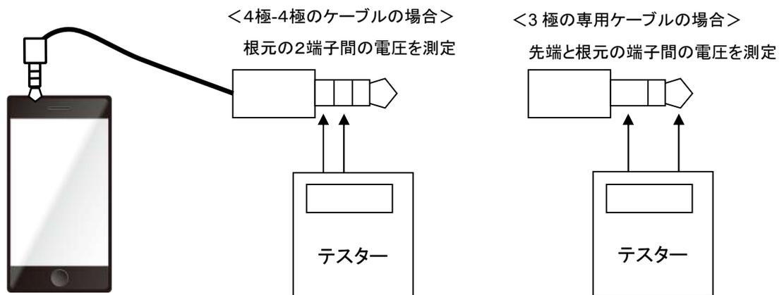
一部機種では常にこのマイク端子に電圧が出ている機種や、着信時の電圧が出ないか低い機種もあります。このような場合は、携帯着信方法の変更を行うか、携帯の機種変更が必要になります。携帯着信方法の変更は、11-13を参照下さい。
