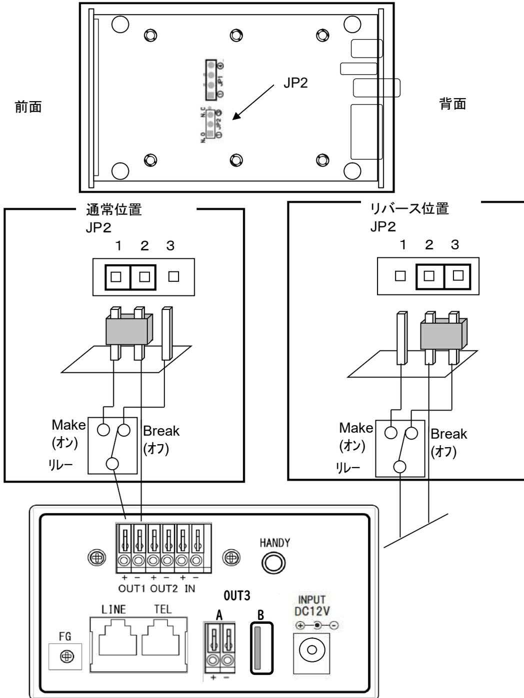
図 17-1 リレー接点出力回路
