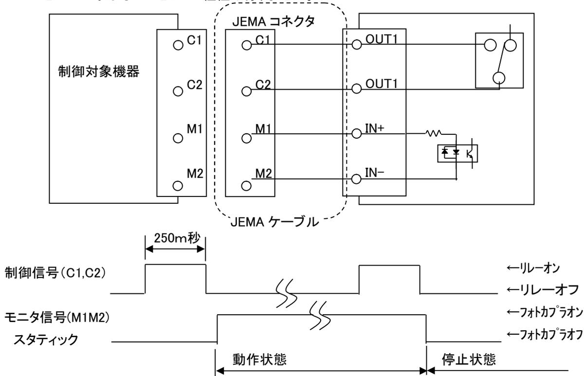
JEMA 端子は別名 HA 端子、JEM1427 端子とも呼ばれています。ルームエアコン、給湯機（風呂）、FF 暖房、床暖房、電動開閉機器、電気錠、電気温水器、照明器具などに使用されています。カタログに上記の端子名があれば制御可能です。
