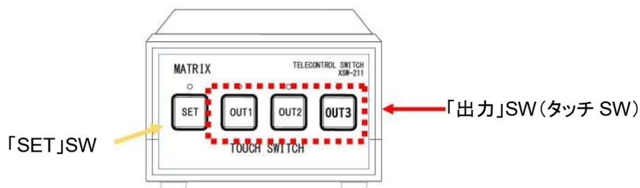
制御機器の出力をオンするには、制御機器が接続されている「出力」ボタンを軽くタッチします。
